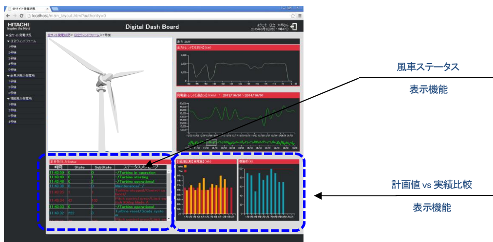
図 4: 保守作業者向け画面では、個々の設備のステータス情報(運用状態のメッセージや障害メッセージ)や設備ごとの計画と実績値の比較情報を表示します。設備の映像がネットワークカメラで撮影されている場合には、ストリーミング映像を表示することもできます。ここでは、設備管理者と「計画値 vs 実績比較」情報を同期し共有しています。このように、画面の同期を行うことで、設備管理者と保守作業者が同一のリアルタイム情報を共有しながら作業を行う事が可能となります。
